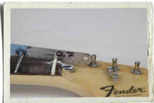
Luta filen ner mot stämskruvarna så strängen vilar i den sida av spåret som är närmast greppbrädan. Se till att spåret blir aningen bredare än strängen. Fila inte för djupt!
