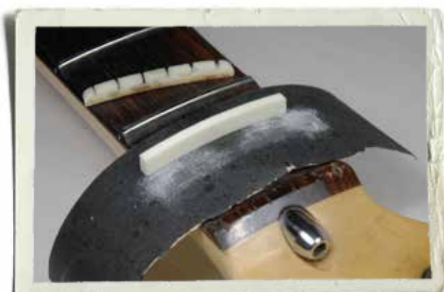
Vissa sadlar är bågformade. Det är bra om sadeln ligger mot botten av spåret efter hela sin längd. Slipa den till rätt radie med greppbrädan som underlag.
