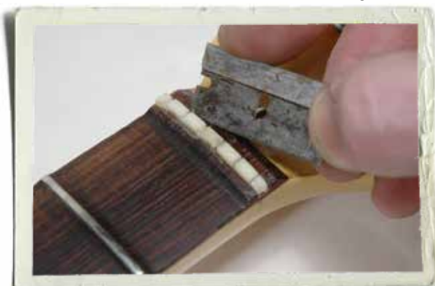
Bryt lim- och lacktytor genom att skära runt hela sadeln så minskar risken för att det följer med trä- och lackflisor när sadeln lossas. Om så sker kan de limmas tillbaka med superlim.
