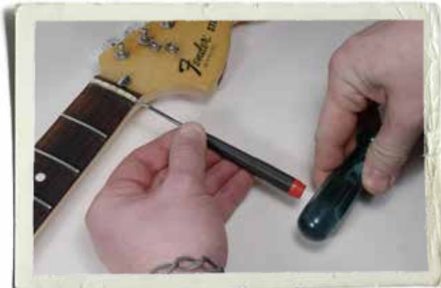
En liten skruvmejsel kilas försiktigt in under sadeln. Räkna med att sadeln spricker vid närmsta spåret.
