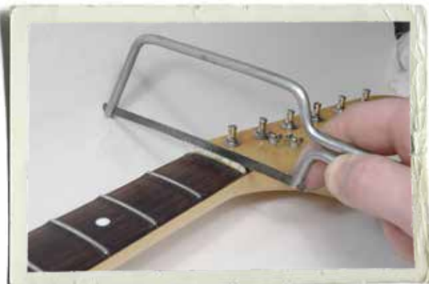
Offra hellre sadeln än greppbrädan! Klyv sadeln med en såg och knacka bort halvorna om den inte vill lossna. Såga inte ner i greppbrädan. Dessa små sågblad är förövrigt bra när man filar skårorna för E, H och G-strängarna efter nerslipning på bredden.
