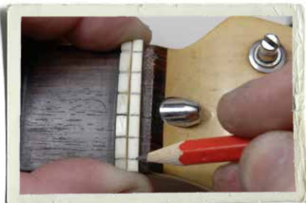
Använd den gamla sadeln som mall när skårorna i den nya sadeln ska märkas upp.
