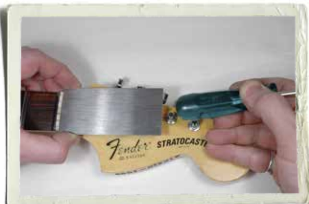
Knacka försiktigt både mot och från greppbrädan. Använd en plåt eller träbit som sprider ut kraften över hela sadeln. Några slag på sadelns ovansida kan också hjälpa till.
